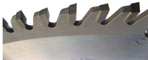
Trennkreissägeblätter für Hobelschnitte in Vollholz längs bis 60 mm Holzdicke, quer bis 100 mm Holzdicke, zum Formatschneiden von unfurnierten oder unbeschichteten Platten in Paketen.
